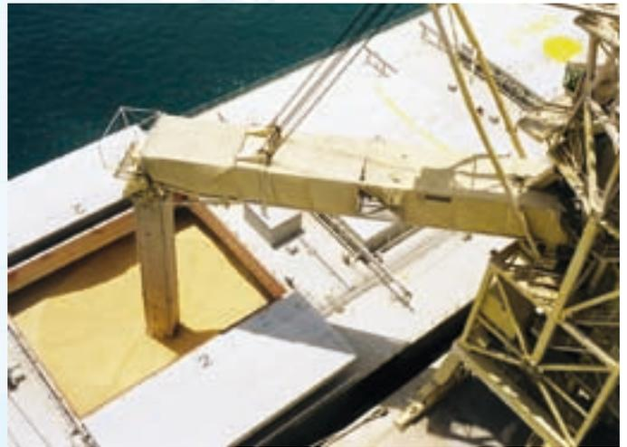
**Getreideentladung 1.000 m<sup>3</sup>/h / Grain unloading 1.000 m<sup>3</sup>/h**
